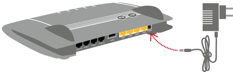
Nach einigen Minuten wird Ihre FRITZ!Box automatisch konfiguriert (die Leuchtdioden „Power/DSL“ und „WLAN“ blinken). Nach Abschluss der Konfiguration (max. 30 Minuten) ist sie einsatzbereit (die Leuchtdioden „Power/DSL“ und „WLAN“ leuchten durchgängig).
